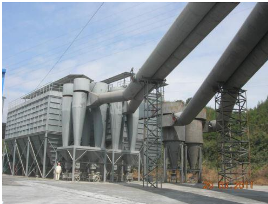
Em 2009, o equipamento de remoção de poeira de ferrocromo de alto carbono em cena
