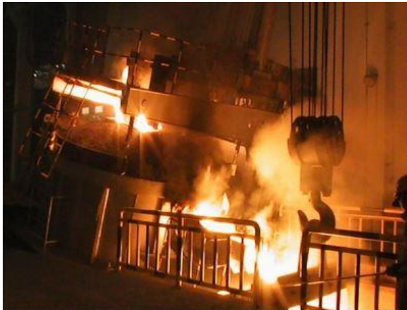
Horno de arco de fabricación de acero, campo de acero
